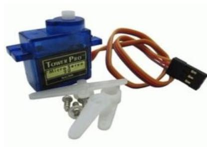
Gambar 5. Motor Servo SG90
